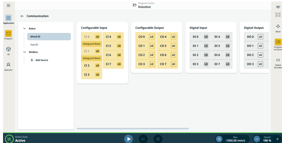
Figuur 1.2: Communicatiescherm met I/O's.
